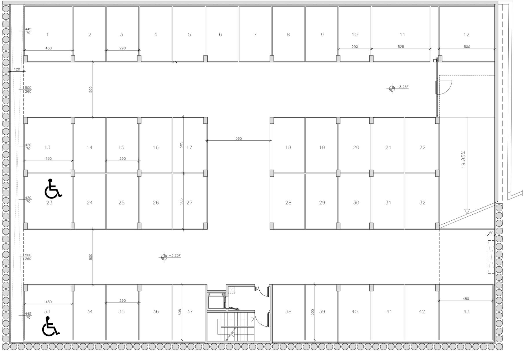
PARTICOLARE DELL'ACCESSIBILITA' ALL'USCITA DI SICUREZZA DI PIANO AI SENSI DELLA L. 13-1989 E SUCC. MOD. ED INTEGR.
