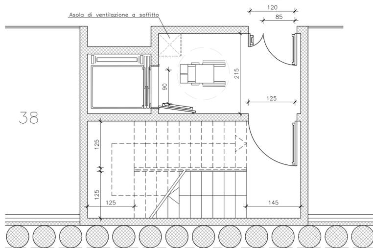
Pianta del nucleo scala-ascensore piano T Rapp. 1:50
